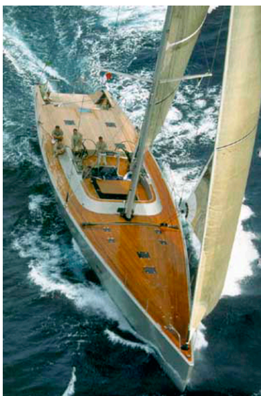
Bild (B024fueZ) Verklebtes Teakholz-Deck (Sika)
