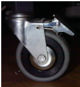
Bild (B101fedZ) Stabfeder an Rolltisch zum Arretieren
