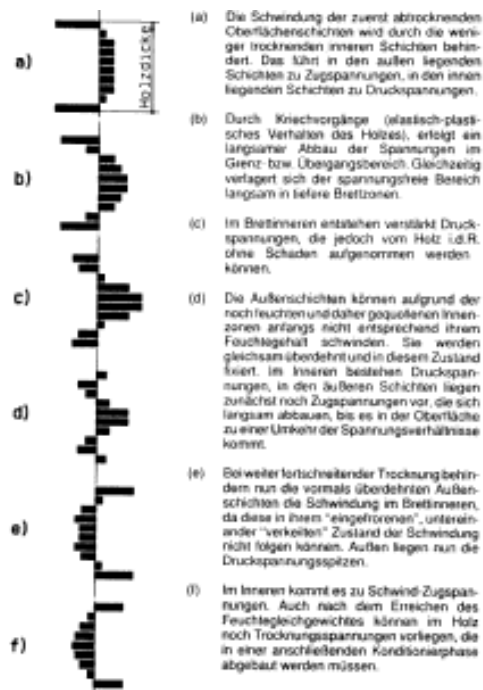
Abbildung 25 Ausbildung des Feuchteprofils und der Spannungen bei der Holz Trocknung
